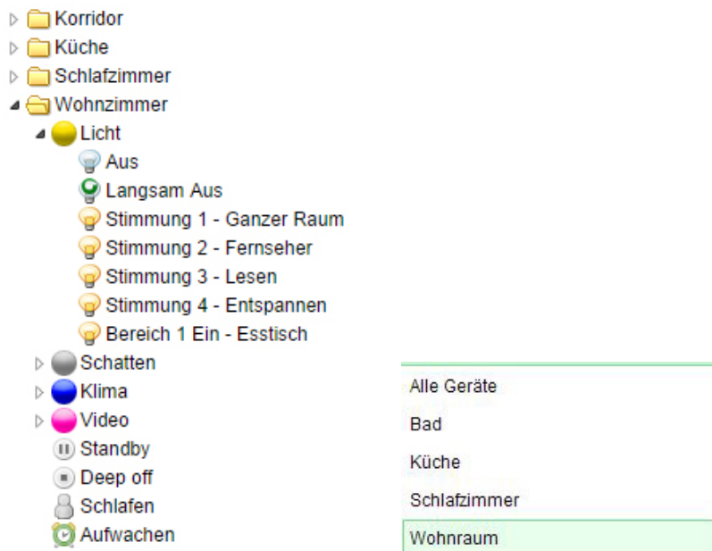
Abb. 22: Baum- und Listenform für Räume oder Stimmungen im digitalSTROM-Konfigurator
